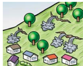
●地面がひび割れ湧水が出る
