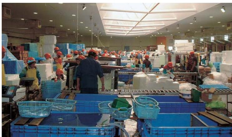
・ 屋根材に膜を採用し照明代を削減しています。
