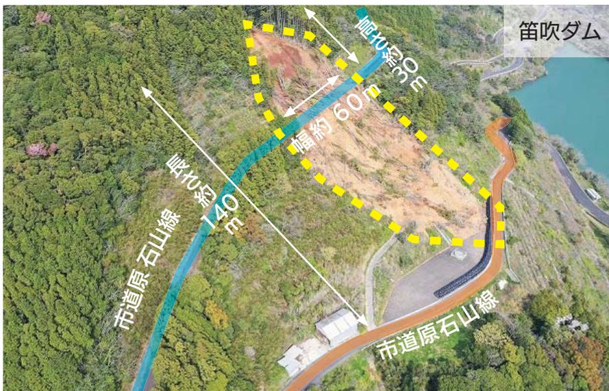
志佐町笛吹地区の市道原石山線において、令和3年8月の記録的な豪雨により、道路法面を含む斜面で幅約60m、高さ約30mに渡る崩壊が発生しました。崩壊した土砂は下方方向に約140m流出したため、斜面下方を通る市道の2箇所、地すべり防止施設および茶畑などに被害があり市道については通行不能となりました。
