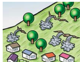
●地面がひび割れ湧水が出る
