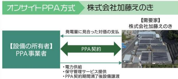
オンサイトPPAにより太陽光発電設備を設置。再エネ自家発電により日中の電力購入量が減ることで、デマンド値(30分間に消費された電力の平均値)を抑えることができ、電気の基本料金を削減できた。
