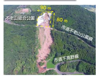
令和元年に幅約90m 長さ約80mの地すべりが発生し、対策工事が進められていましたが、令和3年には令和元年の被災時を越える豪雨により、斜面下部で崩壊が発生し、支えを失った斜面上部まで崩壊が拡大しました。
